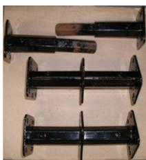
4. Posicionar as facas "1" e "2" no lado que ficará montado no eixo da caixa e fixar com parafuso M10x35, arruela de pressão e porca M10;
