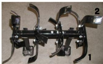
10. Encaixar o disco na lateral das enxadas e fixar com parafuso M8x55, arruela de pressão e porca M8.
